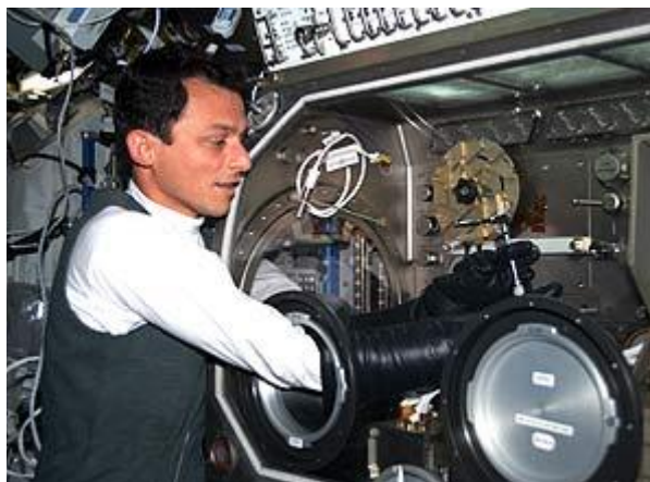
Duque trabaja en el experimento PROMISS, cuyo objetivo es estudiar el crecimiento de proteínas en ingravidez. (ESA)
